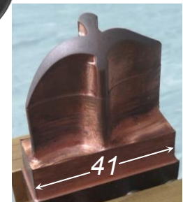
Electrode oiseau usinée en fraisage
