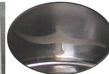
3-Détail gravure par érosion enfonçage sur empreinte polie
